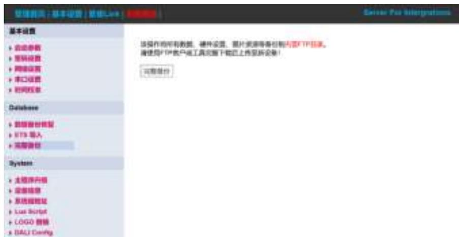
点击“完整备份”，可以将正爵主机/网关内的所有配置：数据文件、资源文件和硬件配置文件等全部备份，以 IP 为 192.168.1.232 的设备举例，用户可在 Windows 操作系统中，打开“此电脑”，在地址栏中输入“ftp://admin:123@192.168.1.232”并回车进入网关的 ftp 文件夹，将文件夹内的所有文件复制并保存。并按照同样的方法，将所有文件粘贴至新的设备 ftp 文件夹内，重启后即可完成数据的完整备份。
