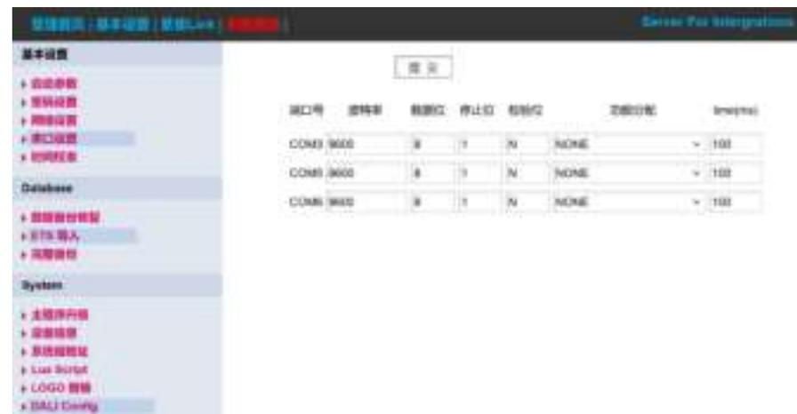
对正爵主机/网关的串口进行功能分配和参数设置，默认为NONE，根据对接设备修改完成相应参数后需点击“提交”并重启生效。
